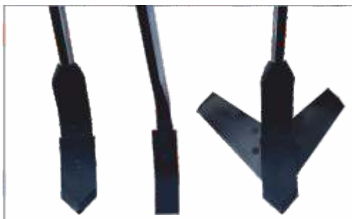
Сборный глубокорыхлитель, долото и сборная лапа культиватора серии К
