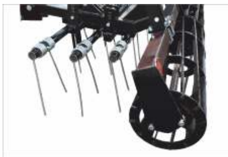
Навесное оборудование: прикатывающий каток и трехрядная пружинная борона
